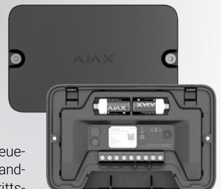
Das Ein- und Ausgangsmodul dient zur Steuerung und automatischen Aktivierung von Brandschutztüren, elektrischen Schlössern, Zutrittskontrollsystemen für Aufzüge, Sprachalarmierungen etc.
